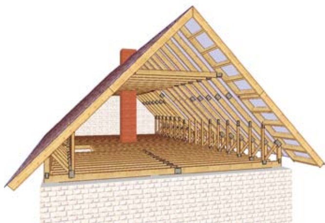
Więźba dachowa na ekranie konstruktora.
