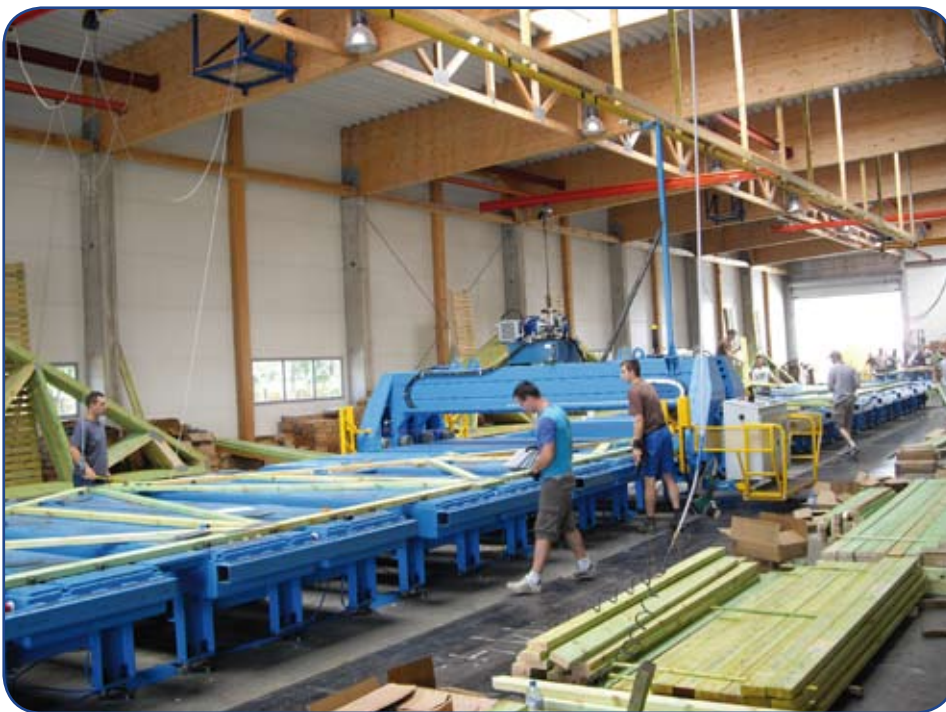
Hala produkcyjna jednego z polskich producentów więzarów – stanowisko prasowania (prasa MARK-I produkcji Mitek Industries).
